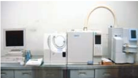
ATD : GC/MS (接着剤中から放散される揮発性有機化合物を検出する)
