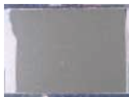
高耐候タイプ 退色、クラックが認められない (薄層部耐候試験後)
