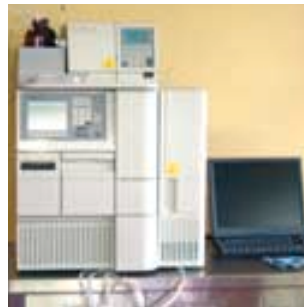
HPLC (接着剤から放散される微量のアルデヒド類を検出する)
