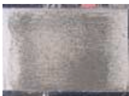
従来タイプ 退色、クラックがある (薄層部耐候試験後)
