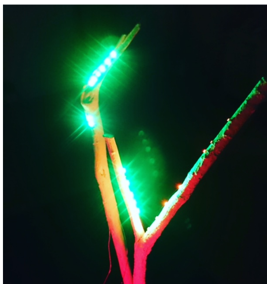
木の枝に【SOLDINE】で回路形成・LED実装して制作した照明
