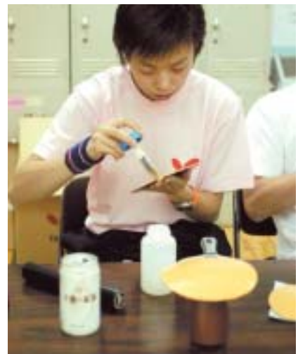
従来の溶剤系接着剤塗布作業 ※中国・張怡寧選手（現女子世界チャンピオン） ※写真提供：株式会社タマス様
